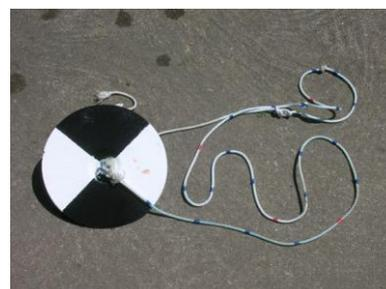
Figure 11 : Photo du disque de Secchi
