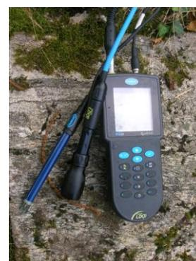
*Figure 13 : Photo de la sonde oxymètre- pHmètre*
