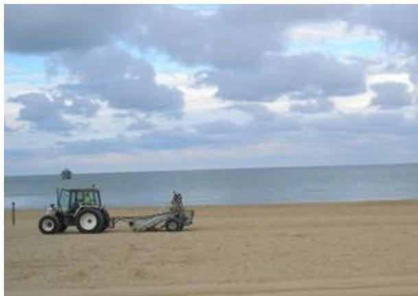
Figure 17 : Le ramassage mécanique avec une cribleuse (Rayer, 2009)
