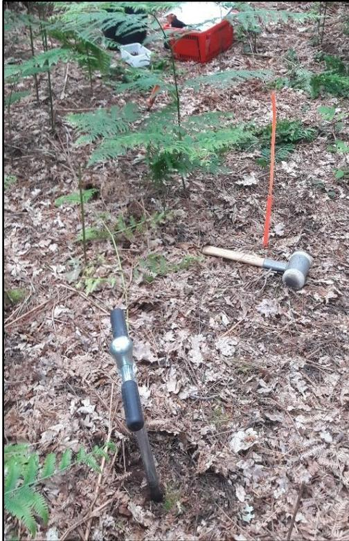
*Figure 11 : mise en œuvre d'une gouge graduée pour les prélèvements de sol*
