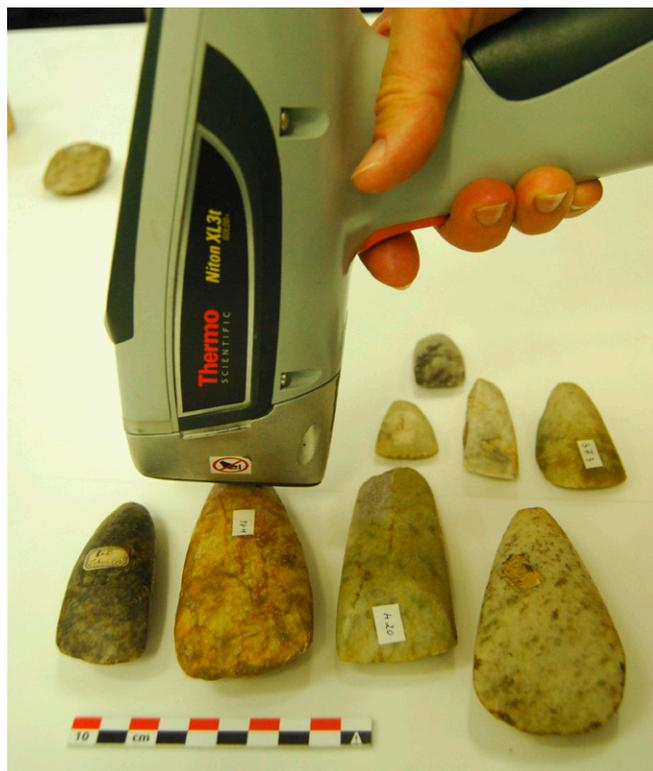
📍 Séance d'analyse chimique de lame de haches polies à l'aide d'un spectromètre portable de fluorescence X © M. Guivarc'h
