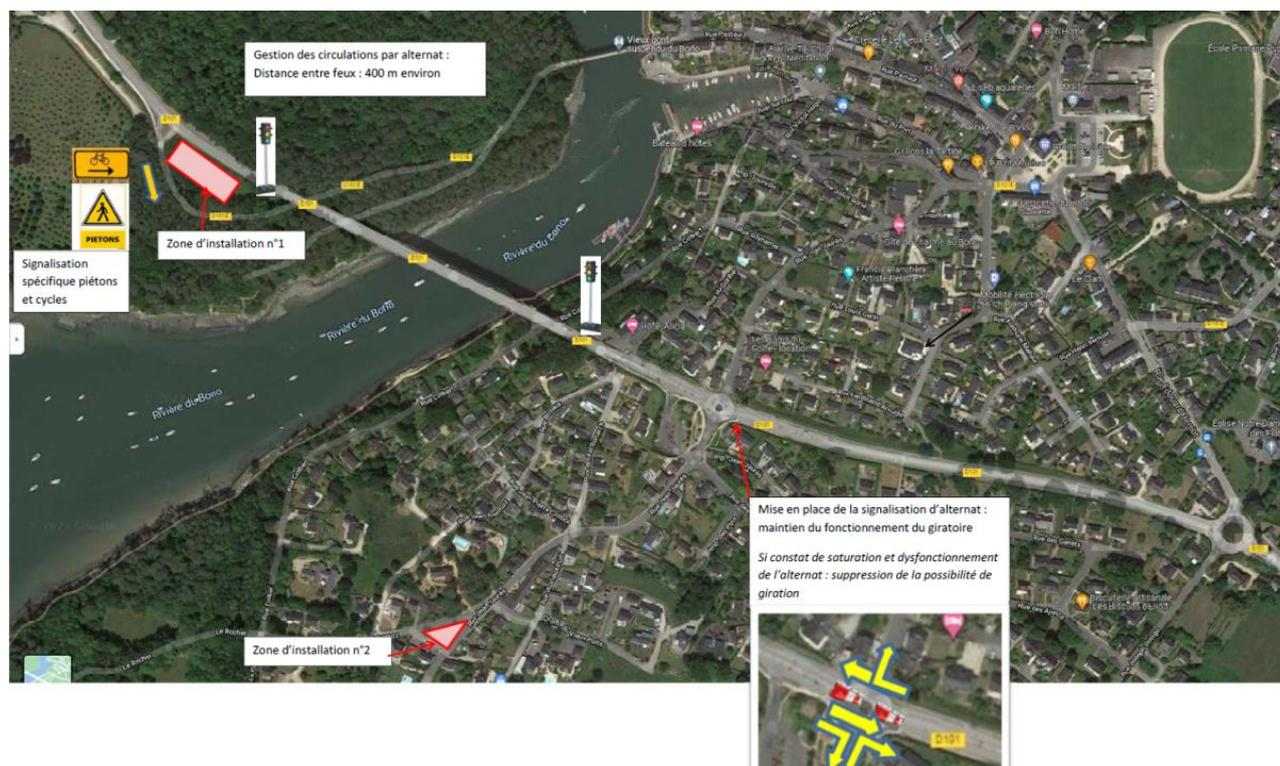
En phase 3, les travaux de rabotage et de mise en œuvre des enrobés seront réalisés sous coupure complète de circulation. La circulation routière et piétonne sera coupée sur l'ouvrage et entièrement déviée pendant 5 jours calendaires consécutifs à compter du 4 juillet 2022 (semaine 27) pour les travaux de rabotage et de mise en œuvre des enrobés. Les déviations routières se feront sur routes départementales suivant le croquis présenté ci-après.
