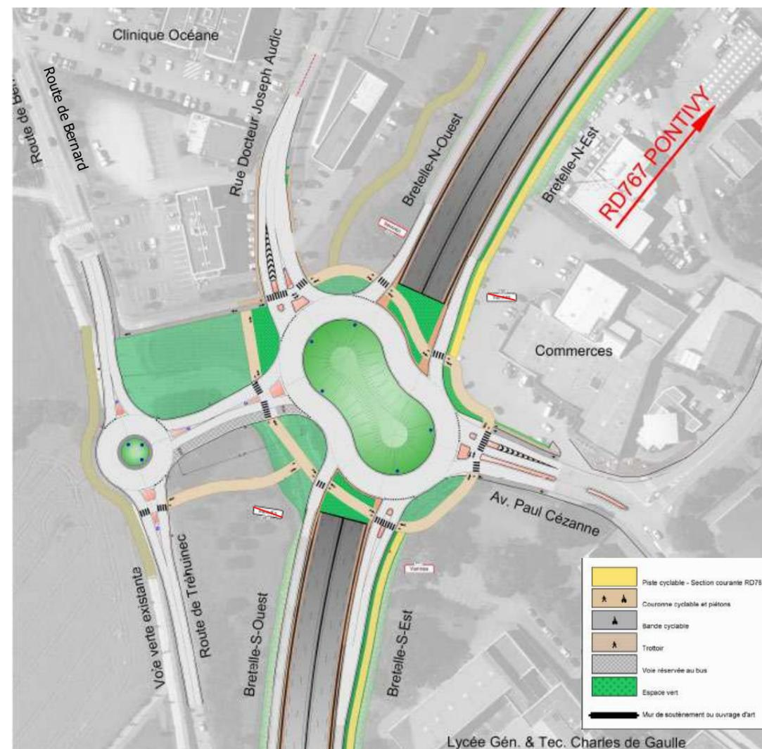
Figure 40 : Géométrie du giratoire dénivelé à Kerniol
