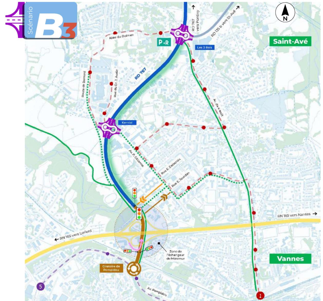
Figure 32 : Représentation schématique du scénario « giratoire dénivelé à Kerniol » (scénario B-3)
