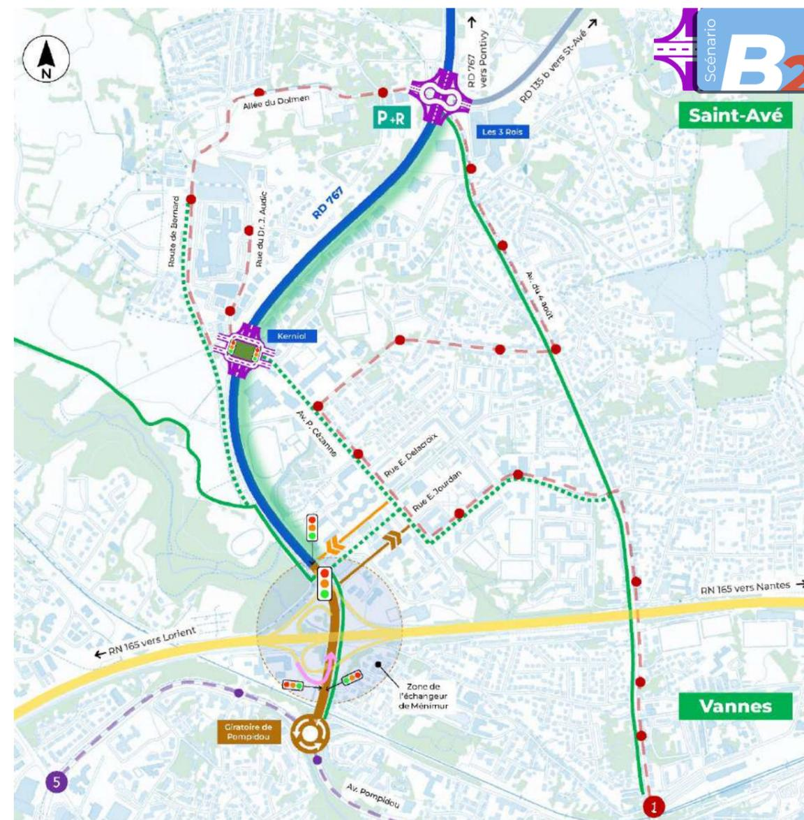
Figure 30 : Représentation schématique du scénario « Place à feux dénivelée à Kerniol » (scénario B-2)
