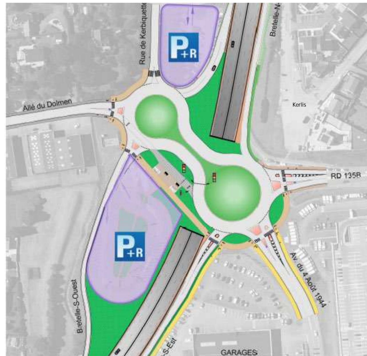
Figure 51 : Géométrie du giratoire cacahuète dénivelé des Trois Rois
