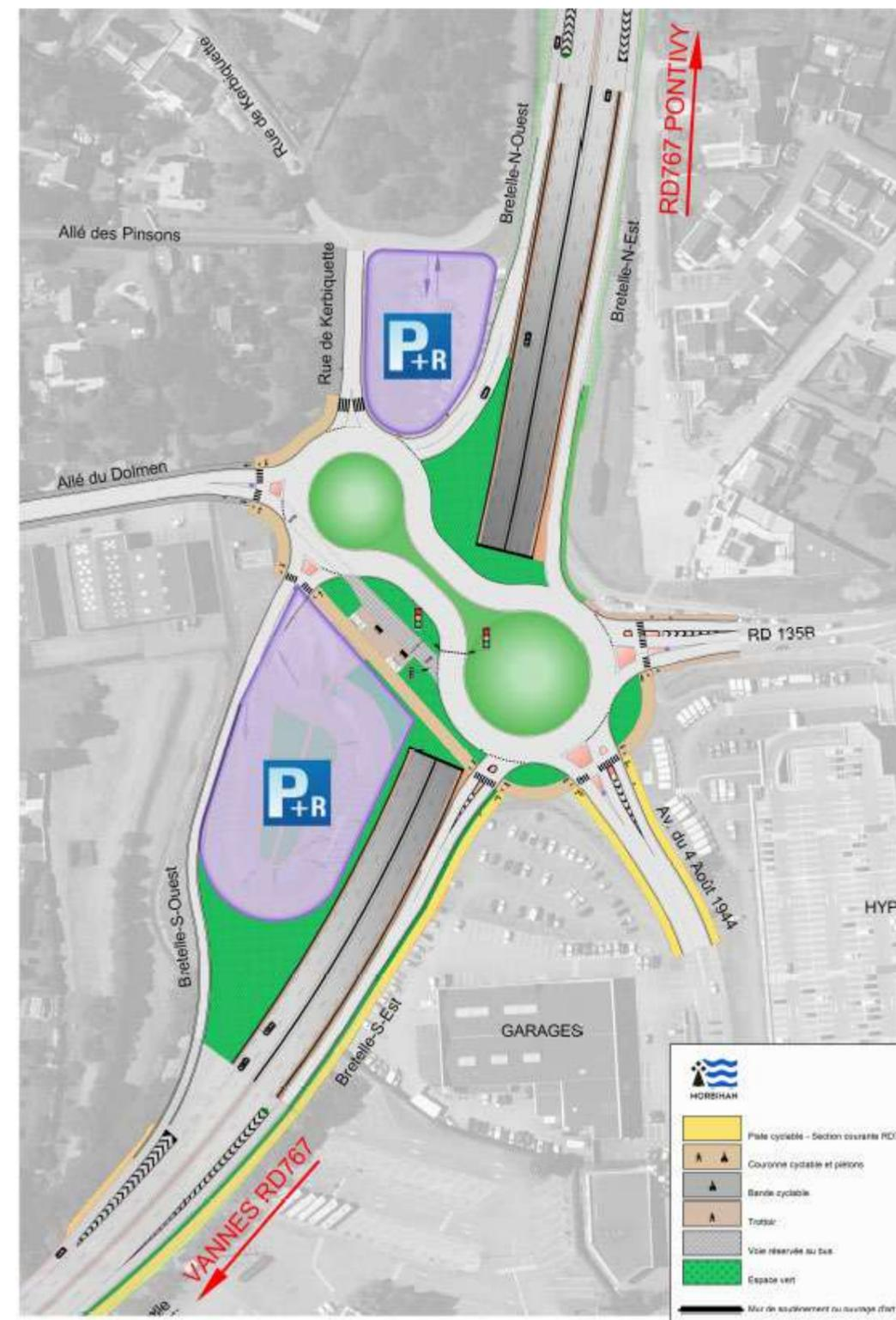
Figure 47 : Géométrie du giratoire cacahuète dénivelé des Trois Rois
