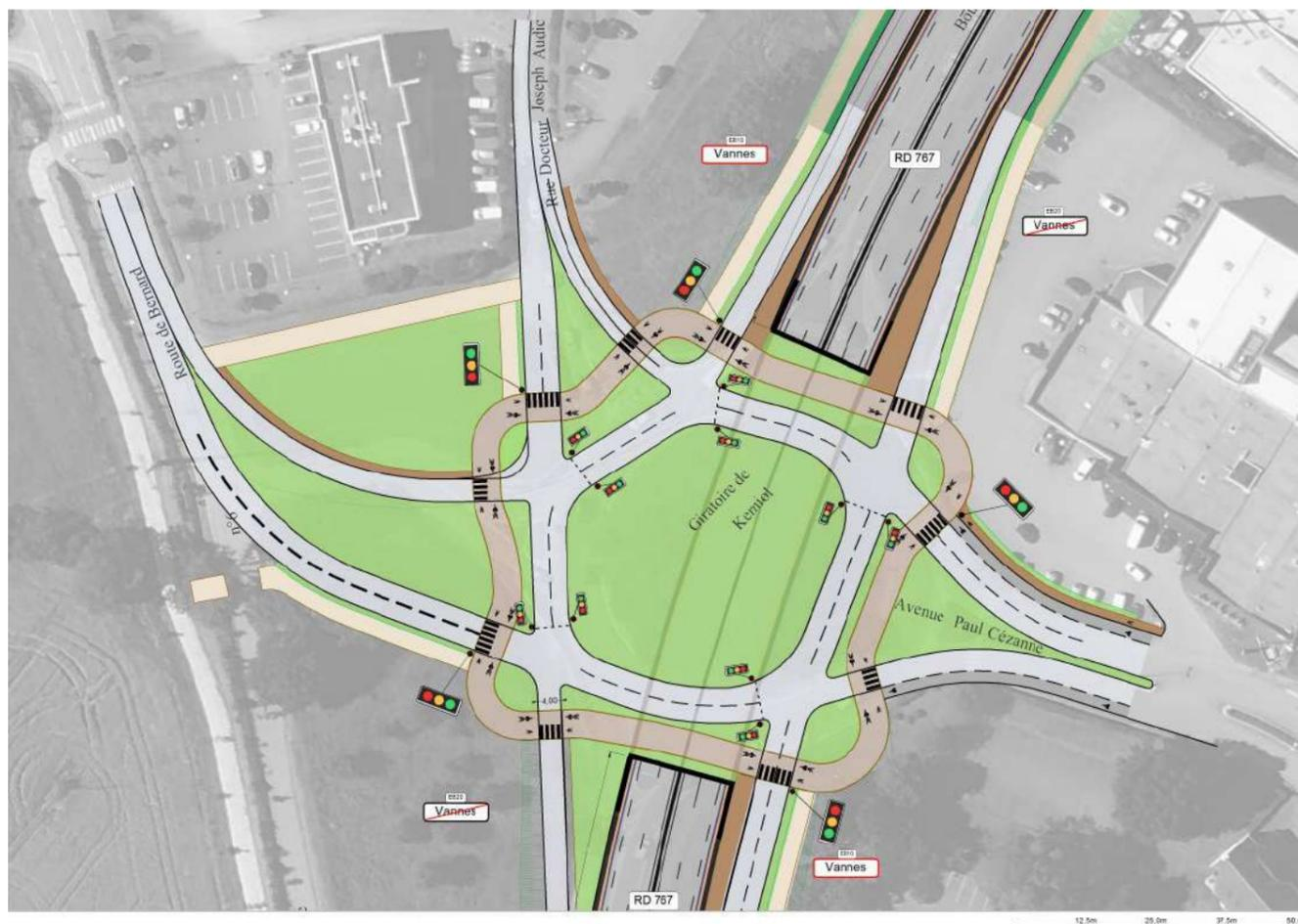
Figure 39 : Géométrie de la place à feux dénivelée à Kerniol
