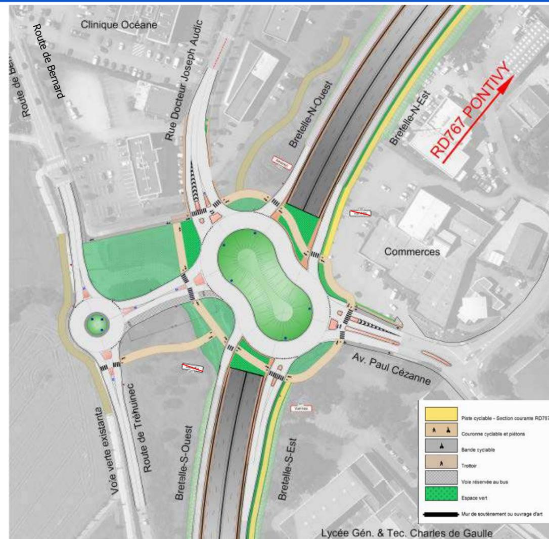
Figure 4 : Géométrie du giratoire dénivelé à Kerniol
